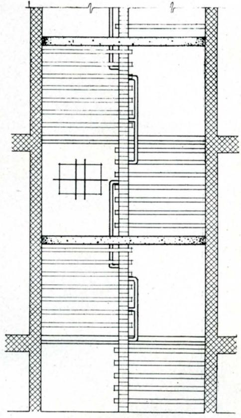
*Detalles de la escalera, hecha con elementos prefabricados que van colocándose al tiempo que se sienta la fábrica de ladrillo.*
